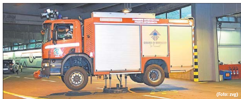
Um auf engem Raum wenden zu können, verfügt das Feuerwehrauto über eine Hebevorrichtung. (Foto: zvg)
